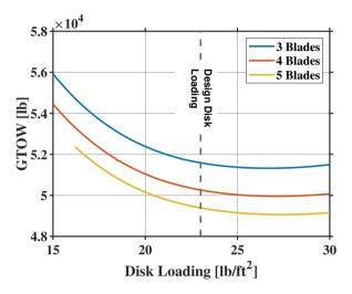
Figure 5.16: Rotor parameter selection
